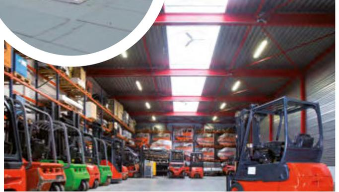
Souvent placées au niveau du faîtage, les voûtes permettent un éclairage naturel abondant, dont l'homogénéité doit être étudiée avec précision afin de ne pas créer des zones sur ou sous-éclairées. Leurs différents systèmes ou natures de remplissage permettent également d'éviter l'apport de chaleur et d'assurer une bonne isolation thermique.
